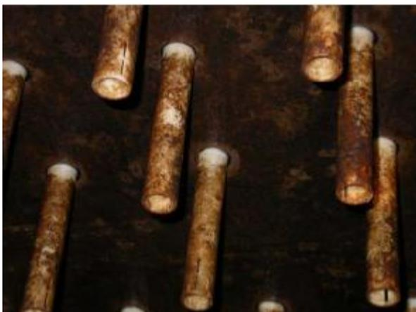
Abbildung 11: Düsenboden von unten einschl. Luftpolsterohrdüs (Quelle: EVERS ENGINEERUNG)
