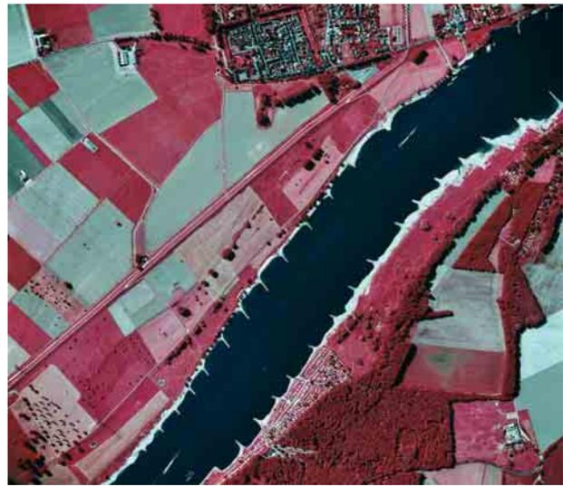
Bild 15: Buhnenausbau bei Zons.
