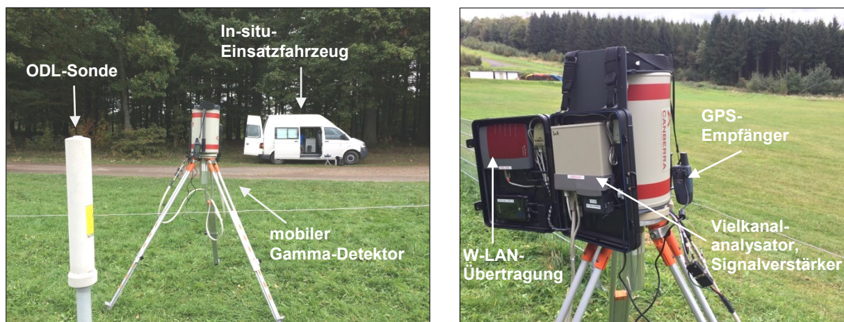
Abbildung 5-5 In-situ-Messung an einer ODL-Sonde
