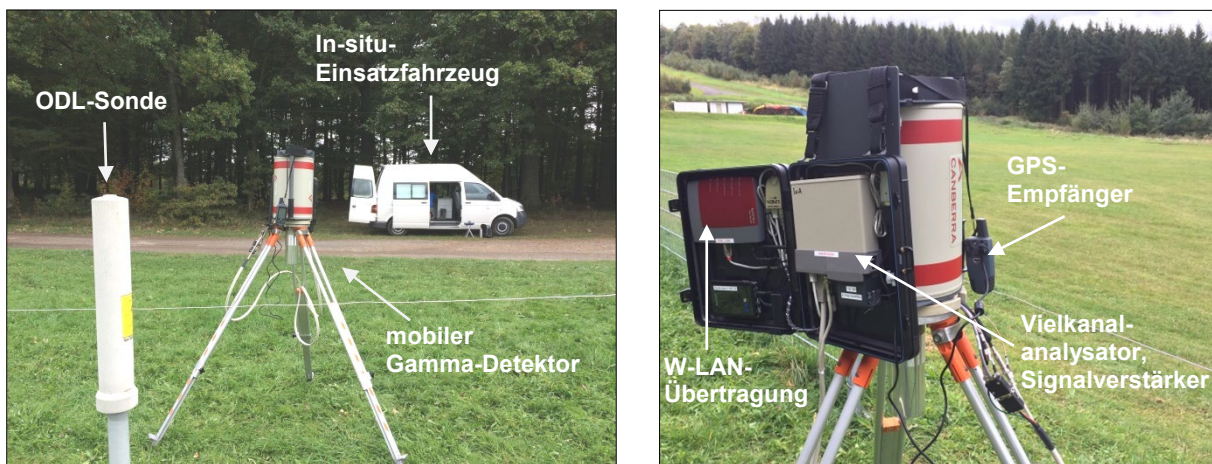
Abbildung 5-5: In-situ-Messung an einer ODL-Sonde
