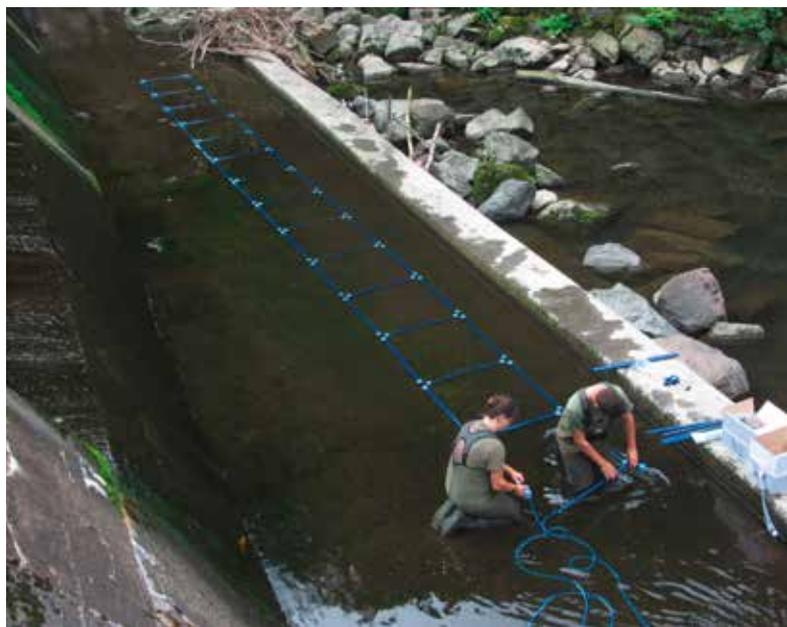
Abb. 7: „Schwimm-durch“-Antenne im Leerschuss des Standortes Auerkotten (links), „Schwimm-drüber“-Antenne am Wehrfuß des Schaltkotten (rechts). Fotos: Institut für angewandte Ökologie GmbH
