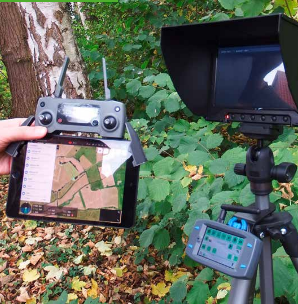
Abb. 5: Die Bedienung der Drohne ist dank Fernbedienung und Tablet sehr einfach. Auf dem Bildschirm rechts wird das Bild der Wärmebildkamera live übertragen. Foto: ABU Soest
