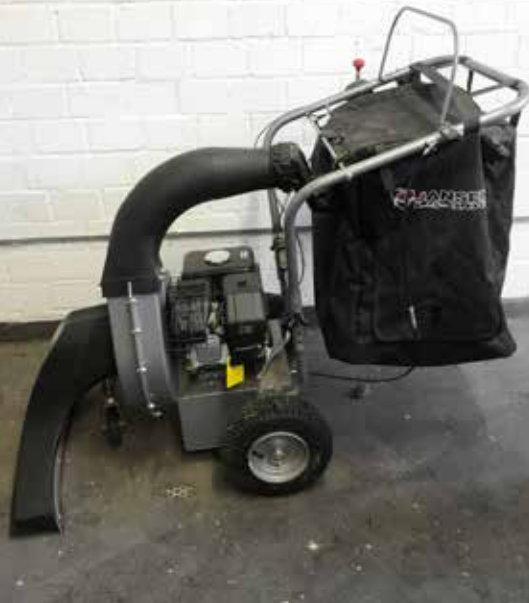
Abb. 13: Modifizierter Laubsauger zur Übertragung artenreicher Grünländer. Das Häckselmesser wurde entfernt, um eingesogene Insekten nicht noch weiter zu gefährden. Foto: Hendrik Thies
