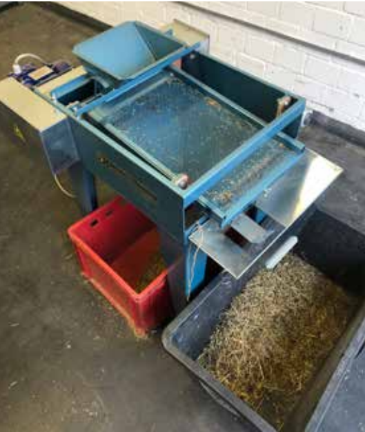
Abb. 8: Vor dem Kauf wurde das Rüttelsieb mit dem Druschgut getestet. Foto: Hendrik Thies
