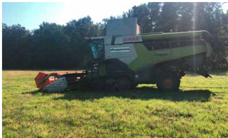
Abb. 5: Einsatz eines Großdreschers mit Raupenfahrwerk am 11.09.2023, um den feuchten Boden zu schonen. Aufgrund der Sommertrockenheit war der zweite Aufwuchs gering. Dadurch gelangte zu wenig und gleichzeitig feuchte Biomasse in den Drescher. Foto: Hendrik Thies
