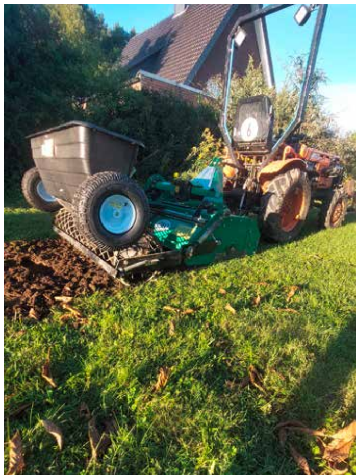
Abb. 12: Modifizierte Umkehrfräse mit Saatkasten. Aktuell läuft noch eine Glattwalze nach, um den Bodenschluss zu erzeugen. Diese Methode sorgt für optimale Wuchsbedingungen und ist zudem effizient und kostengünstig. Foto: Tobias Albert
