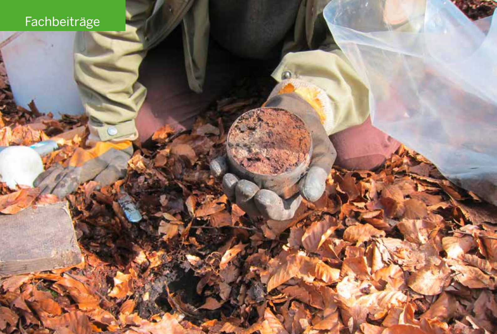
Abb. 1: Stechzylinderprobe aus fünf Zentimeter Mineralbodentiefe. Foto: Ute Hamer
