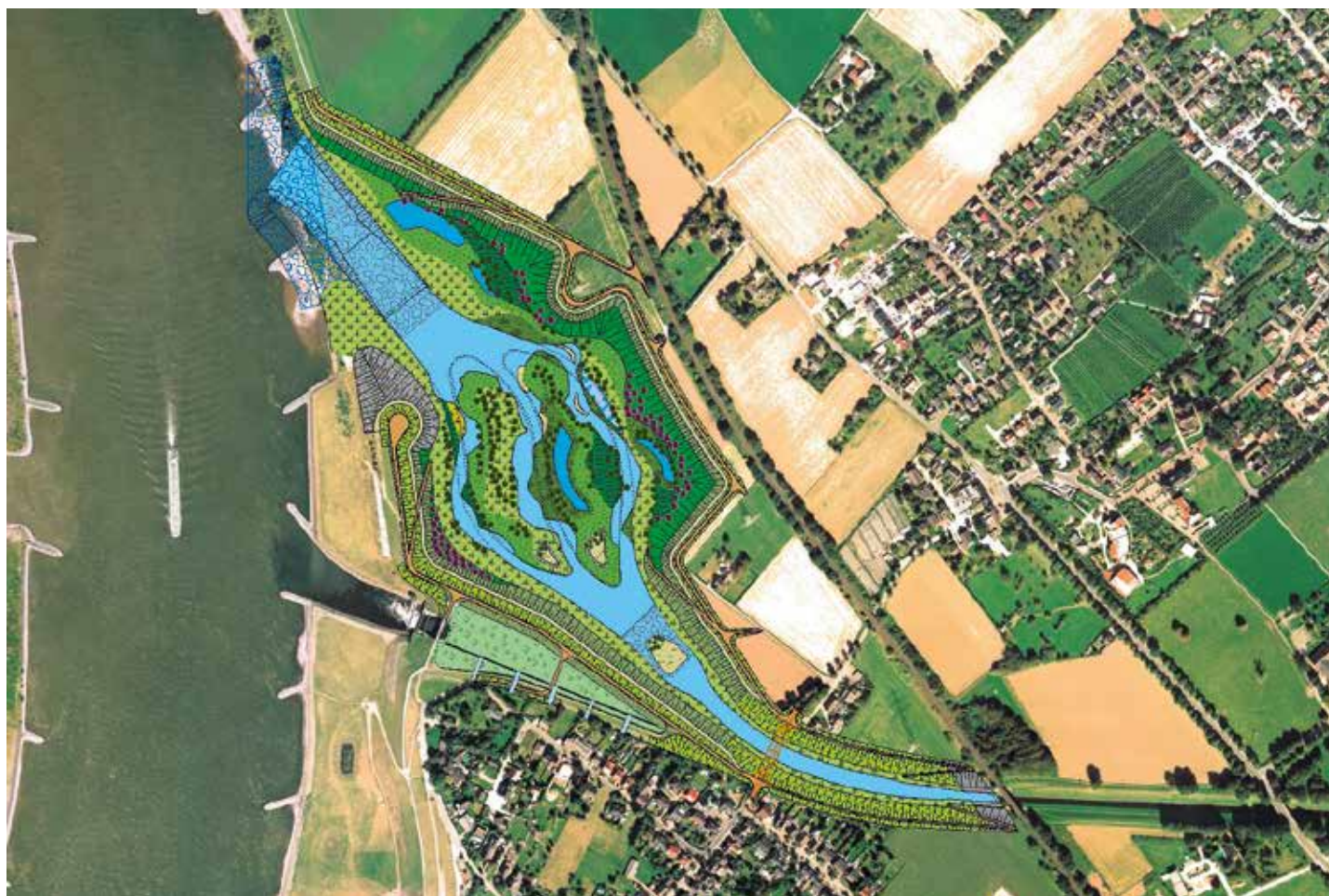
Abb. 3: Planung für den Umbau der Emschermündung (blau = Flussdelta, grüne Flächen = Vegetationsflächen). Luftbild: EGLV
