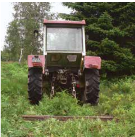
Abb. 9: Zum „Knüppeln“ des Adlerfarns hat sich ein Schlepper mit angehängtem Stahlträger bewährt
