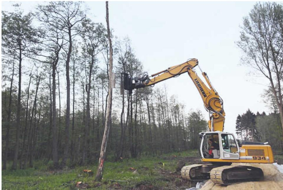
Abb. 6: Vorsichtiges Niederlegen eines Höhlenbaums mittels Bagger mit Greifwerkzeug.
