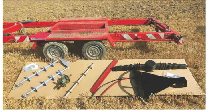
Zugelassene Materialien für den Vogelschutz: Langstabilisolator (im Vergleich zum kurzen Glaskappenisolator im 10-kV-Netz), Abdeckhauben und Schrumpfschläuche.
