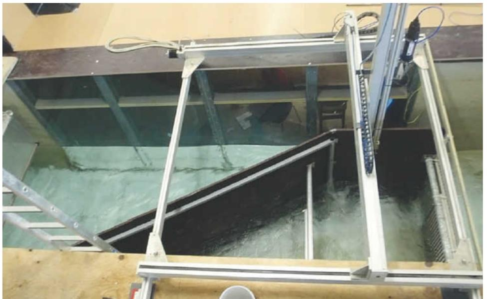
Modell der Wasserkraftanlage im Theodor-Rehbock-Wasserbaulaboratorium im KIT.
