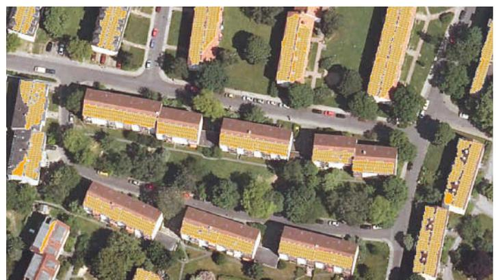
Abb. 4: Belegung der theoretischen PV-Eignungsflächen mit PV-Standardmodulen
