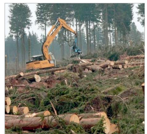
Ein Harvester arbeitet kurz nach Kyrill das Holz einer Windwurffläche auf.
