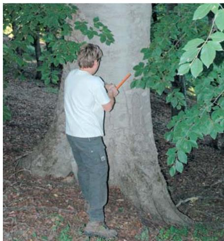
*Einer Rotbuche wird eine Holzprobe mit Jahrringen entnommen. Dazu muss ein Zuwachsbohrer in den Stamm eingeführt werden.*
