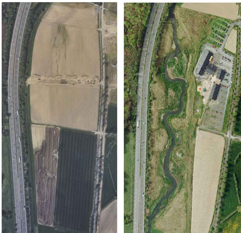
Abb. 3: Gewässerverlegung eines schottergeprägten Flusses des Grundgebirges bei Lohmar (links vorher, rechts nachher) (Quelle: Aggerverband)
