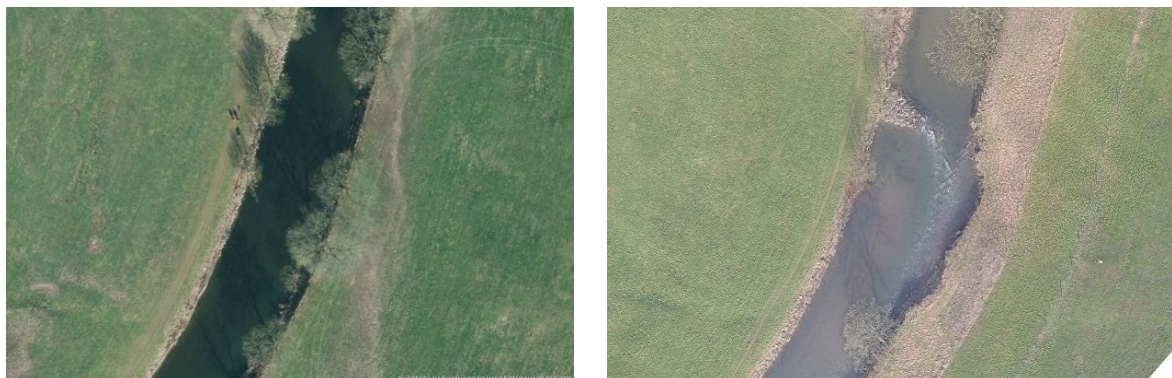
Abb. 46: Beginnende eigendynamische Entwicklung einer Sekundäraue an einem schottergeprägten Fluss des Grundgebirges (Agger bei Donrath); links: Vorzustand; rechts: nach Umsetzung Initialmaßnahmen (Einbau Strömungslenker) (Fotos: Aggerverband)
