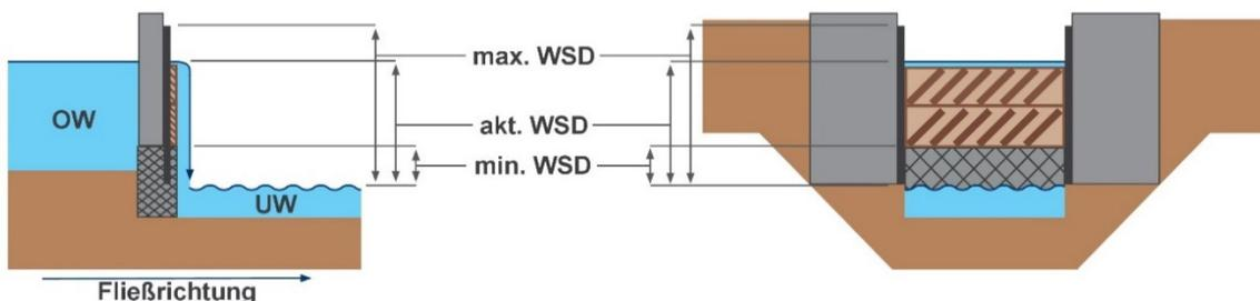
**Abbildung:** Bewegliches Wehr im Längs- und Querschnitt, Verschluss teilweise geschlossen, Sockel vorhanden – die minimale, die aktuelle und die maximale Wasserspiegeldifferenz haben unterschiedliche Werte
