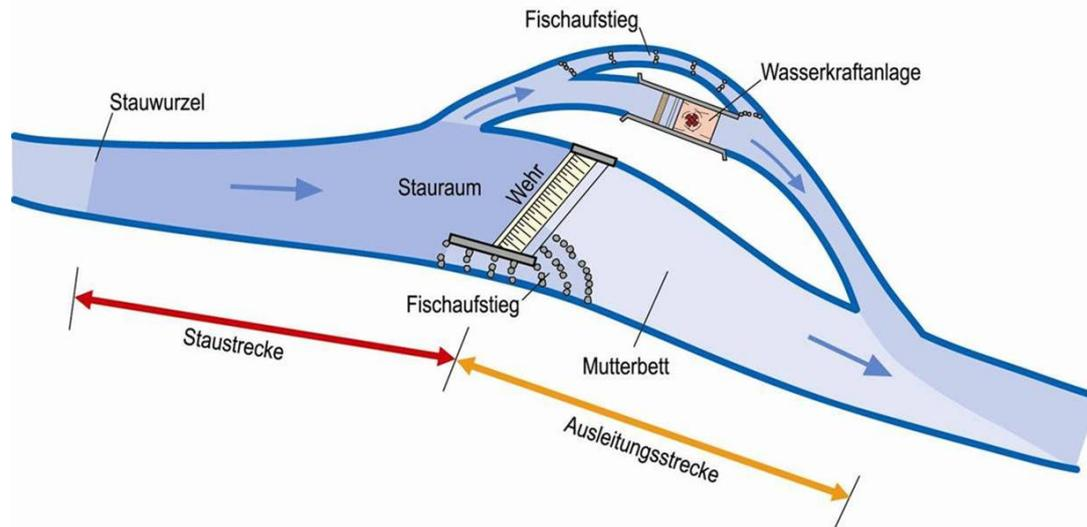
**Abbildung:** Bauwerk mit Ausleitung (MUNLV 2005). Der Ausleitungskanal befindet sich in Fließrichtung links und führt durch die Wasserkraftanlage; als Ausleitungsstrecke wird der Gewässerabschnitt zwischen Wehr und Wiedereinmündung des Ausleitungskanals bezeichnet.
