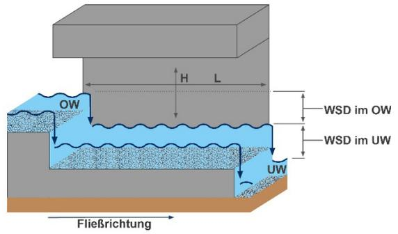
**Abbildung:** Durchlass im Längsschnitt mit Wasserspiegeldifferenz im Unter- und Oberwasser
