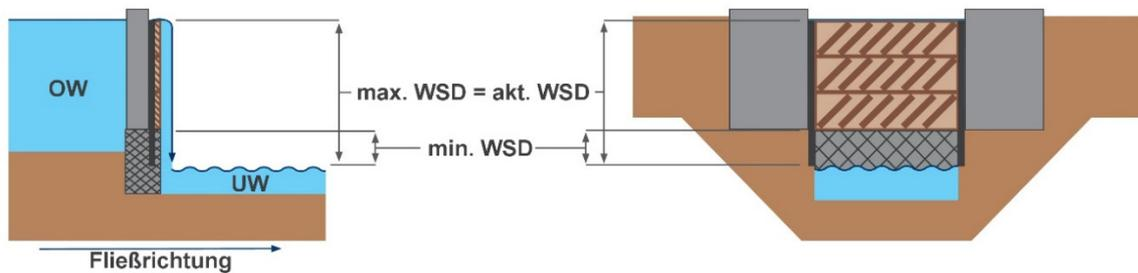
**Abbildung:** Bewegliches Wehr im Längs- und Querschnitt, Verschluss geschlossen mit Sockel – die maximale Wasserspiegeldifferenz entspricht der aktuellen Wasserspiegeldifferenz
