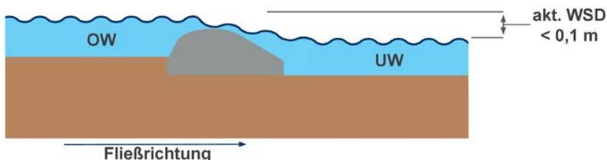
**Abbildung:** Bauwerkstyp „Schwelle“ (Stützschwelle) im Längsschnitt mit geringer Wasserspiegeldifferenz
