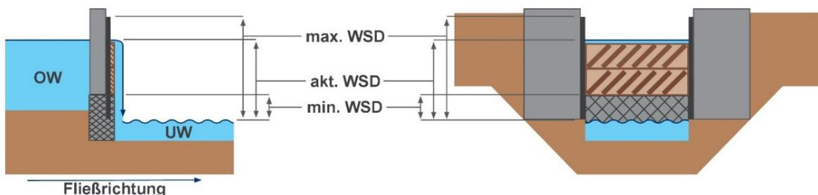
**Abbildung:** Längs- und Querschnitt (Blick vom Unterwasser aus) eines Beweglichen Wehres mit Sockel
