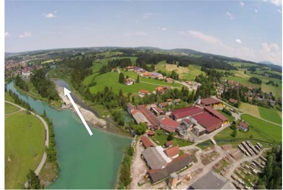
Ausleitung, nahezu 80 % des Wassers; Ausleitungsstrecke in Pfeilrichtung
