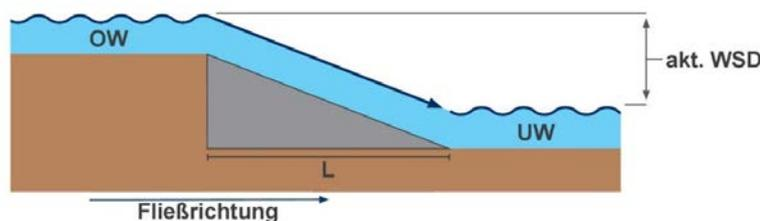
**Abbildung:** Bauwerkstyp „Absturz“ im Längsschnitt mit Neigung 1:3 (steil), keine Rampe
