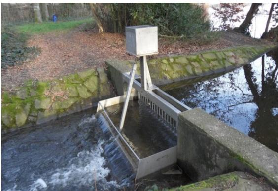
Wasserstandsmessgerät, nicht als Bauwerk zu erheben
