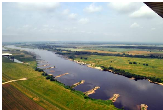
Profil mit Buhnenausbau
