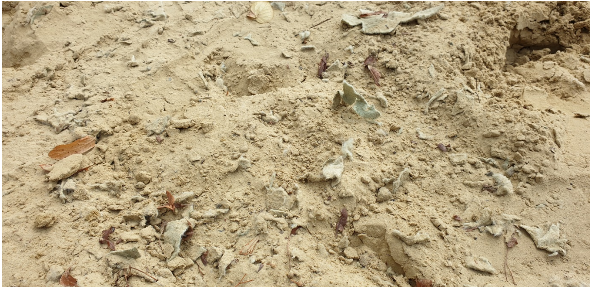
Abbildung 1: Sand-Kunststoffgemisch als Tretschicht auf einem Reitplatz
