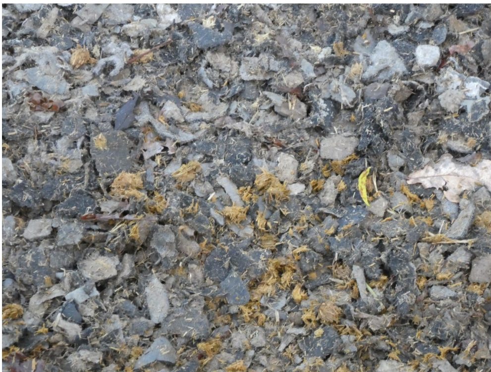
Abbildung 3: Vollsynthetische Tretschicht mit Anteilen an Laub und Pferdedung
