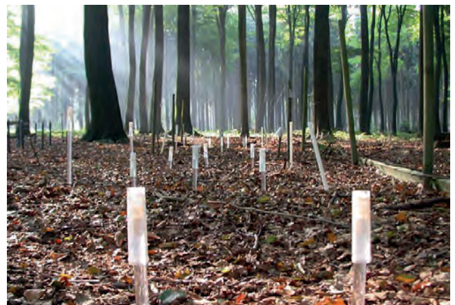
Mit Tensiometern wird die Bodensaugspannung gemessen
