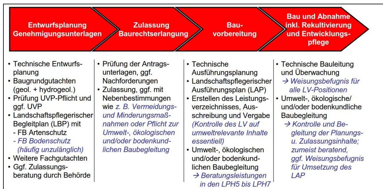
Abb. 3–1: Bodenschutz in den unterschiedlichen Phasen eines Bauvorhabens
