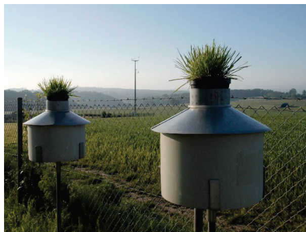
Abbildung 5: Expositionsvorrichtung mit Graskulturen
