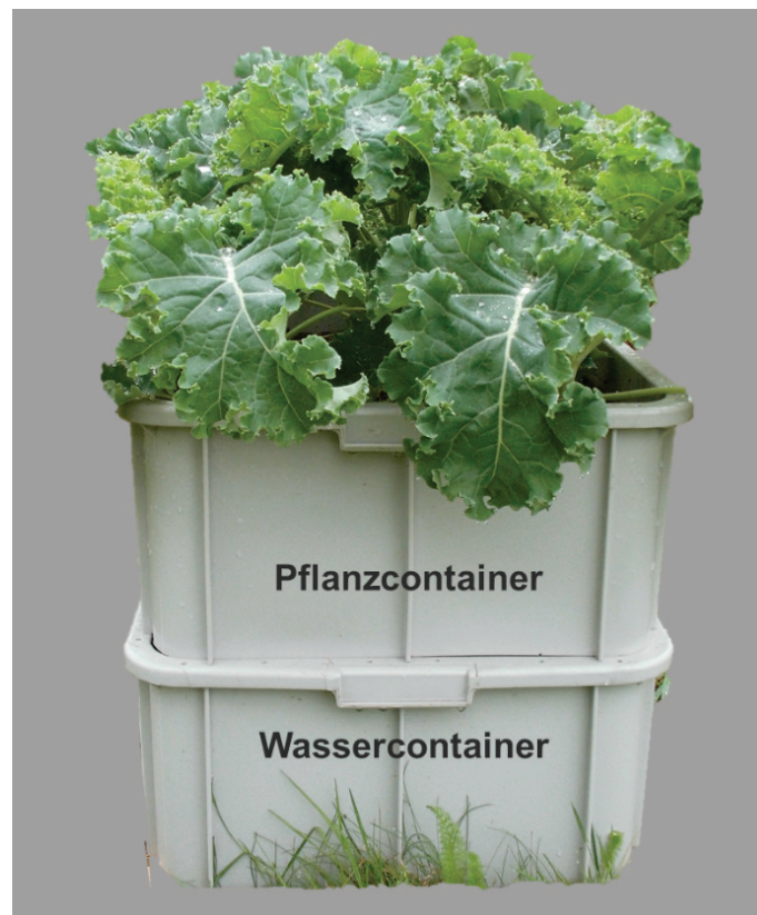
Abbildung 7: Grünkohlexposition nach VDI 3957 Blatt 4
