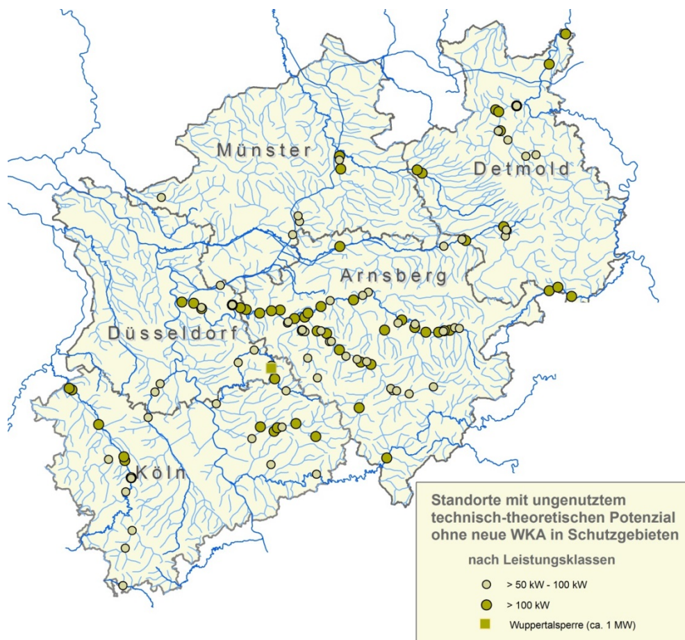
Abbildung 19: Standorte potenzieller Wasserkraftanlagen nach Leistungsklassen (maximales Szenario)
