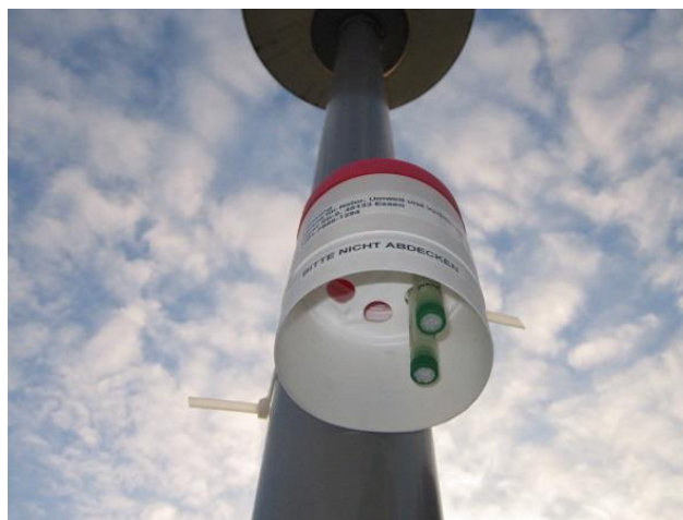
Abbildung 1: Typische Probenahme mittels Passivsammler
