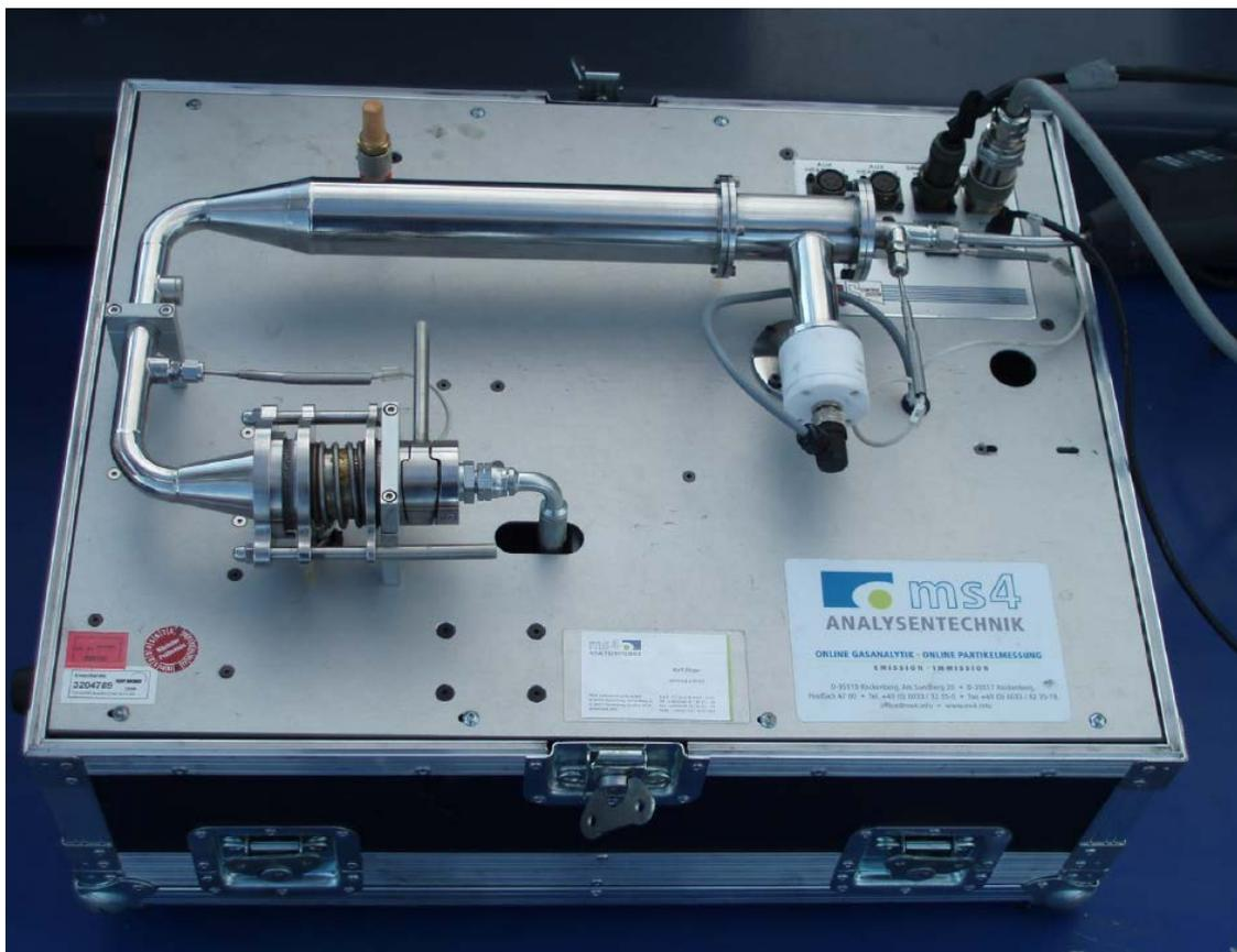
**Abbildung 10:** Gravimetrisches Partikelmessgerät Micro PSS [Quelle: Busch LANUV]
