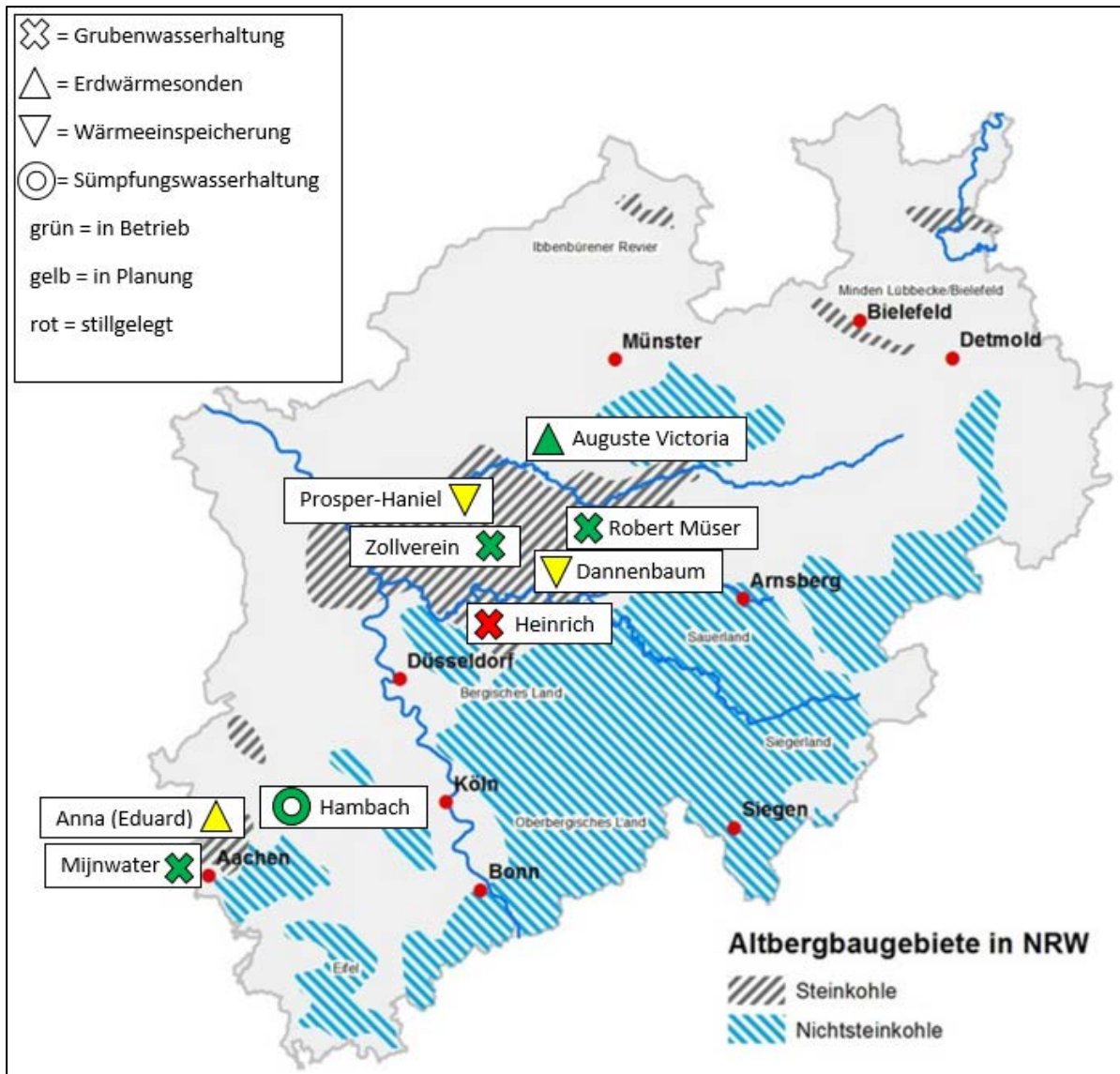
Abbildung 2: Projektstandorte Grubenwassernutzung in NRW und Heerlen (geändert nach Bezirksregierung Arnsberg, 2018)
