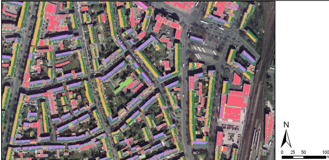
Abbildung 4.7: Dachflächenenerkennung (Luftbild: Geobasis.NRW)
