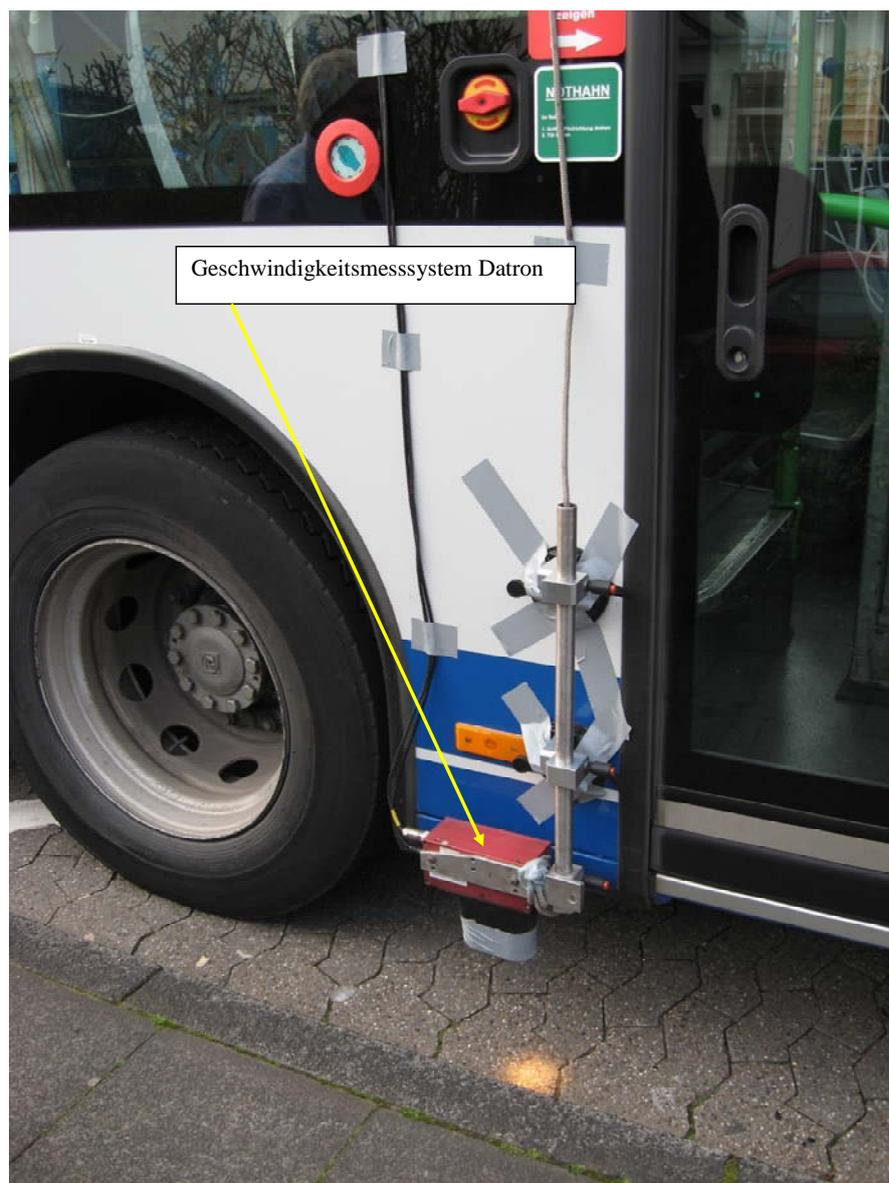
**Abbildung 10:** Geschwindigkeitsmesssystem am Fahrzeug
