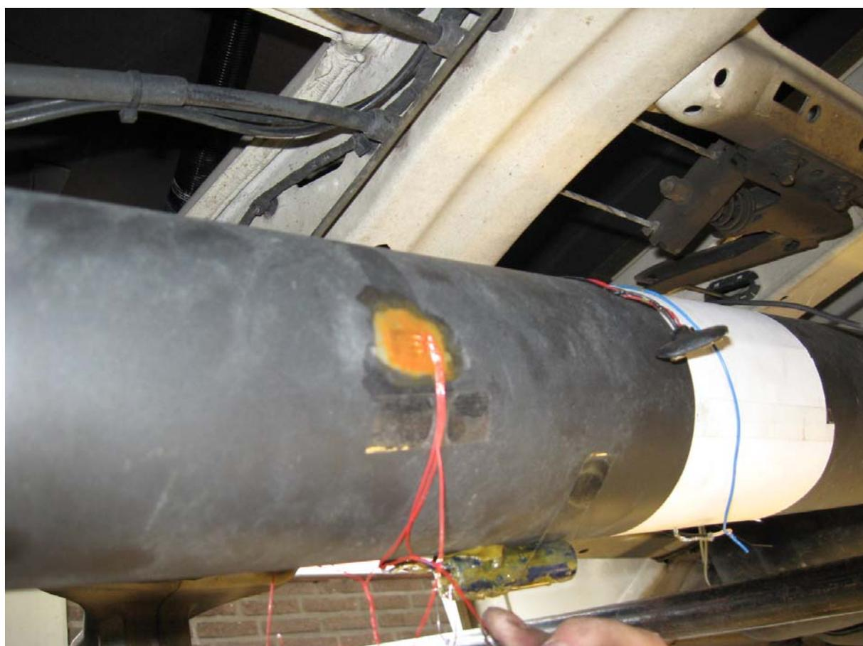
**Abbildung 9:** Dehnmessstreifen im Rohzustand
