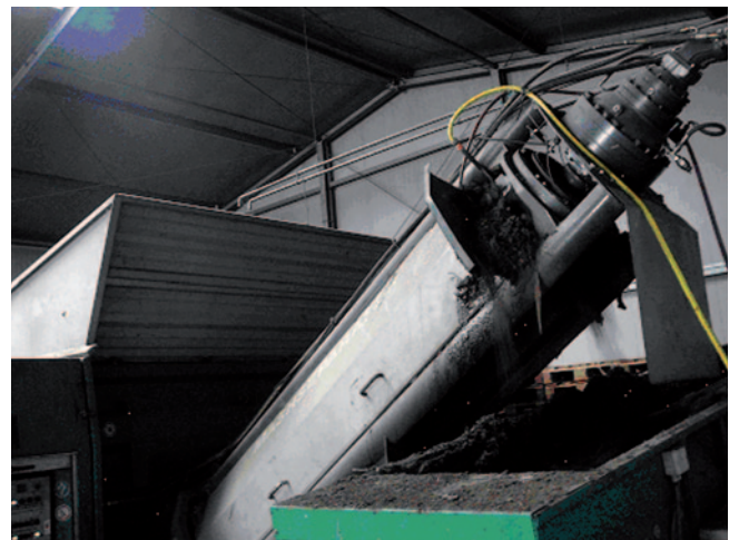
Abbildung 3: Mashseparator mit Mischbehälter im Hintergrund und Schneckenpresse
