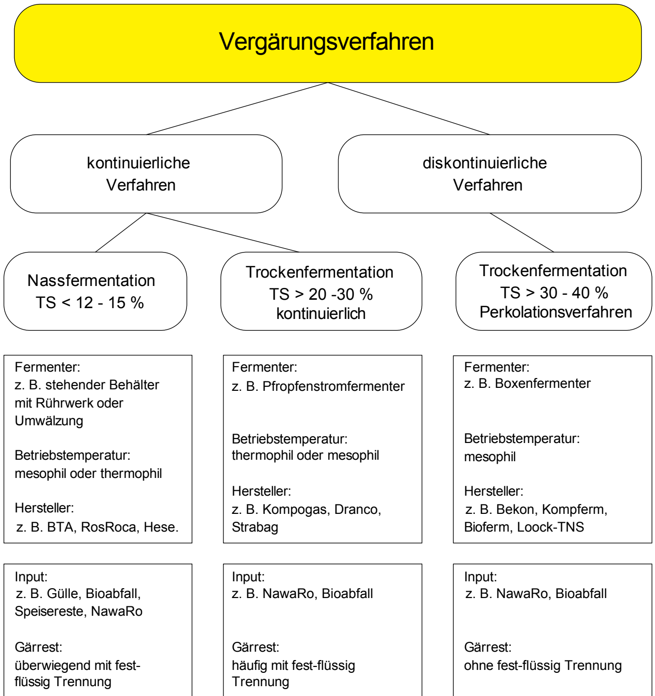
Abbildung 1: Übersicht über kontinuierliche und diskontinuierliche Vergärungsverfahren
