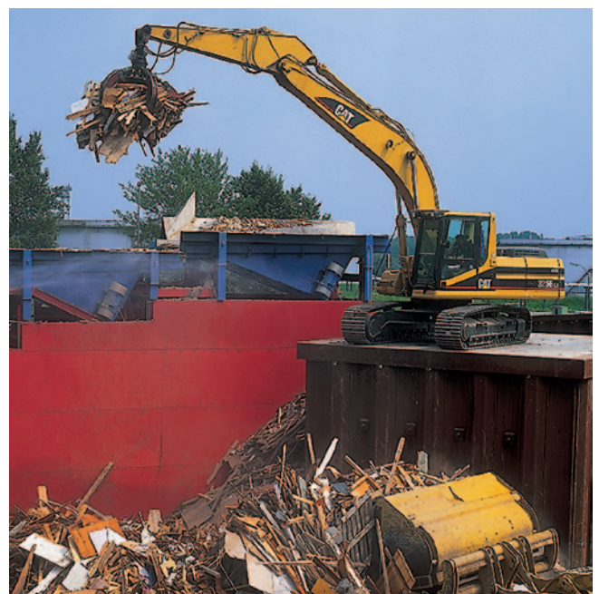
Aufgabe von Altholz zur Aufbereitung (Quelle: EnBW Biomasse GmbH)
