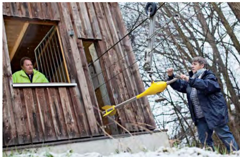
Beatrix Miercke und Uwe Fiedler bereiten in Brake an der Aa den Messflügel für die Abflussmessung vor
