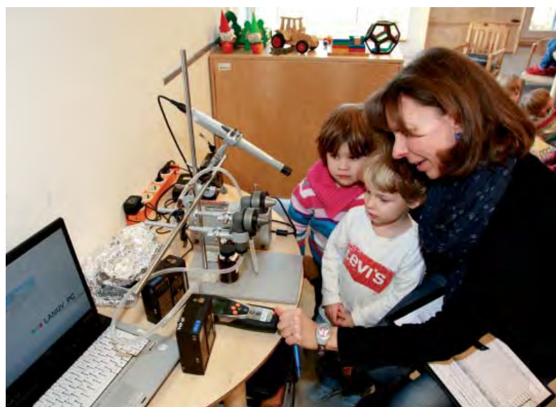
Probenahmesystem zur Bestimmung der Phthalate in der Raumluft
