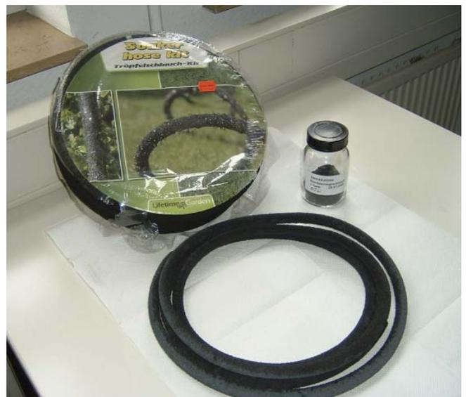
Neuer und gebrauchter Tröpfelschlauch sowie Laborprobe
