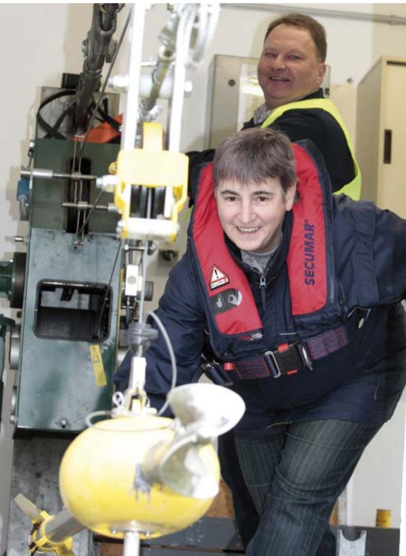
Uwe Fiedler und Beatrix Miercke setzen einen hydraulischen Messflügel ein, mit dem die Fließgeschwindigkeit des Wassers bestimmt wird
