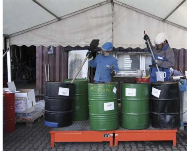
Um eine Unterscheidung zwischen Produkt und Abfall zu ermöglichen, war die Erfassung möglicher Phasen von besonderer Bedeutung. Durch den Einsatz von Stechhebern wurden Teilproben aus dem Bodenbereich und dem oberen Drittel der Behälter entnommen. Die Beurteilung des Behälterinhaltes erfolgte nach Abfüllung der Proben in Probengefäße aus Klarglas. Bei der Verwendung des Schichtenhebers konnte die Beurteilung im Probenahmegerät erfolgen.
