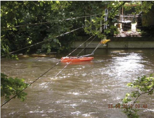
Abflussmessung am Pegel Gronau/Dinkel mit einem ADCP-Messgerät im Messboot
