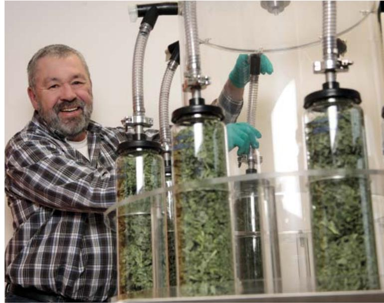
Vor der Analyse von Grünkohlproben prüft Johannes Köhler, ob der Trocknungsprozess des Grünkohls in der Gefriertrocknungsanlage bereits abgeschlossen ist
