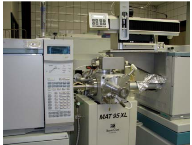
Hochauflösende Gaschromatographie-Massenspektrometrie zur Spurenanalyse von Dioxinen, Furanen und PCB
