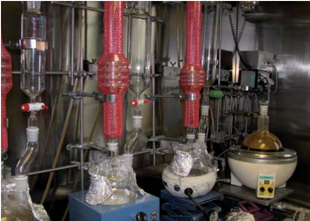
Extraktion von organischen Inhaltsstoffen aus verschiedenen Matrices (Pflanzen, Böden, Sedimente etc.) zur Analyse auf Dioxine, Furane und PCB
