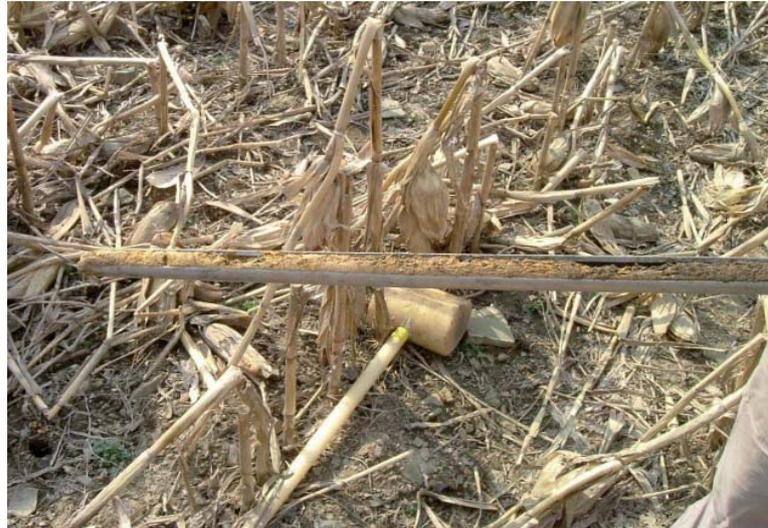
Bodenprobe von der hoch belasteten Fläche
