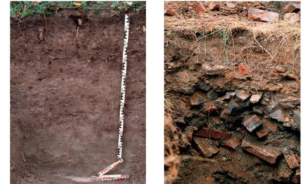
Der naturnahe Boden links kann auf einem Quadratmeter Fläche rund 250 Liter Wasser für Pflanzen verfügbar speichern, der Bauschuttboden rechts dagegen nur 150 Liter.
