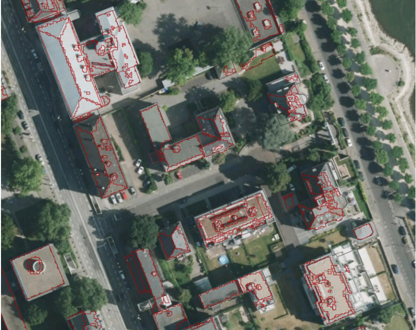
Abbildung 4: Beispiel für die Zerlegung der Dachflächen in homogene Teilflächen. Erkennbar sind viele kleinteilige Dachstrukturen, wie zum Beispiel Schornsteine und Gauen.
