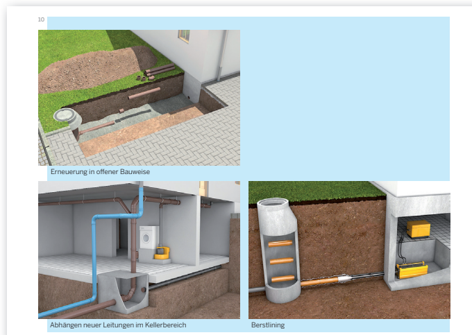
Bild 3: Faltblatt „Sanierung privater Abwasserleitungen“, Bildbeispiele zur Erneuerung
