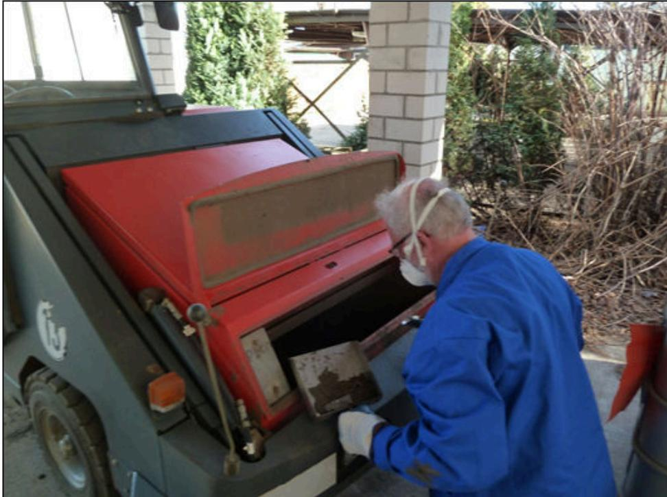
**Bild 13:** Probenahme Probe 5 aus dem Auffangbehälter der Kehrmaschine
