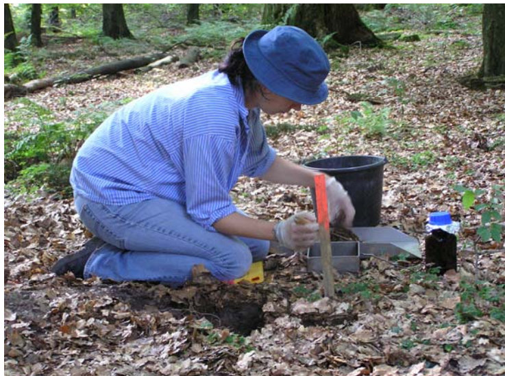
Abb. 3: Sandra Gommer (Dipl. Ing. Bodenkunde) entnimmt eine flächenbezogene Probe der Humusaufgabe zur Bestimmung persistenter organischer Schadstoffe
