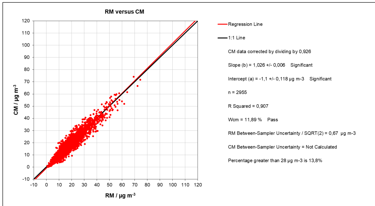
Abbildung 4: Orthogonale Regression DURAG F-701-20 PM 10 , gesamtes Datenkollektiv (bereinigt um Ausreißer) mit einem Faktor von 1,08
