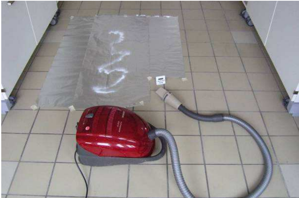
Abb. 5: ALK-Abello Staubprobensammler am Staubsauger während Blindwert-Versuch
