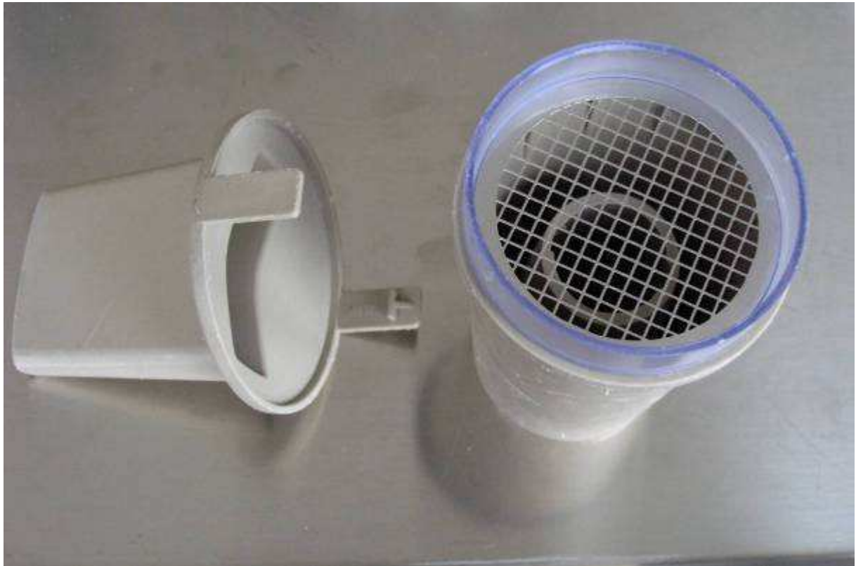
Abb.4: ALK-Abello Staubprobensammler mit Edelstahl-Stützgitter
