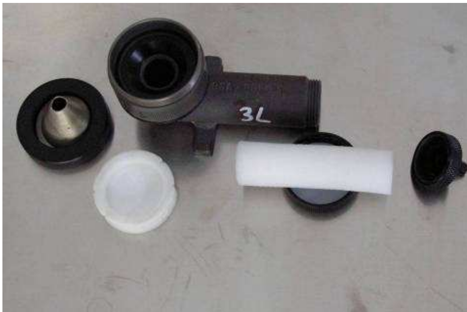
Abb. 2: GGP-Probenahmekopf mit Filterkassette mit bestücktem Glasfaserfilter und PU-Schaum-Plugs
