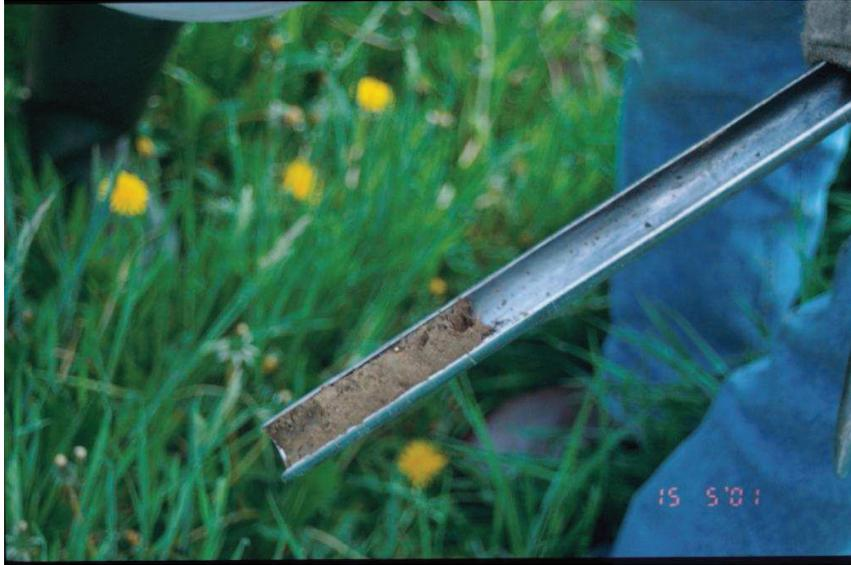
*Abb. 7 Beprobung einer Grünlandfläche mit dem sogenannten Pürckhauer-Bohrstock.*
