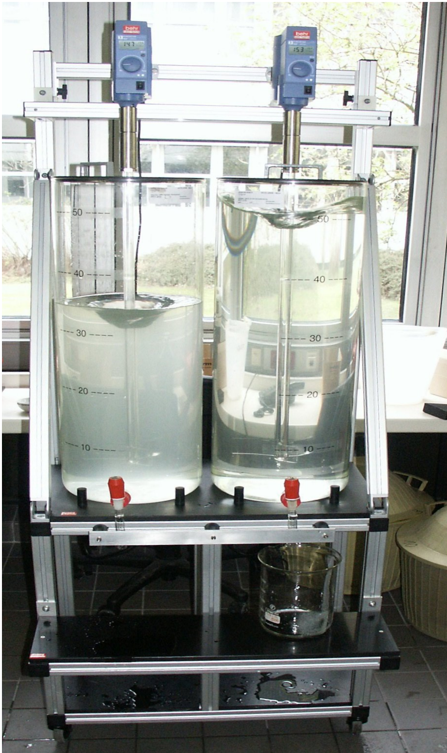
Apparatur zur Homogenisierung der Wasserproben
