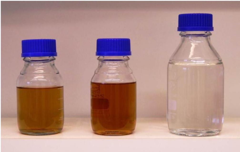
**Bild 8-11** MBR Ablauf (links), aufkonzentrierter MBR Ablauf (Mitte) und Permeat (rechts)
