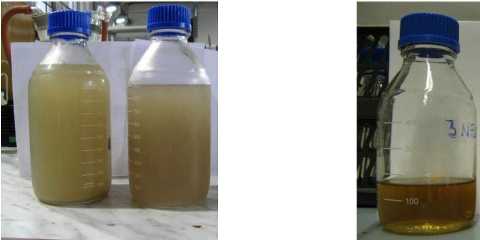
**Bild 4-32** Abwasser der Fasertrennung (links) und des Gesamtablaufs der Abwasserreinigung der Stora Enso Kabel
