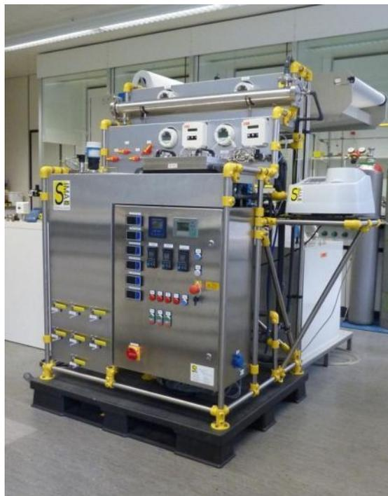
**Bild 8-8** Simatec Teststand für die Nanofiltrationsexperimente
