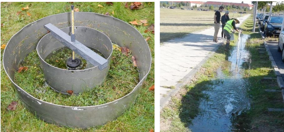
Abbildung 2: Messung der hydraulischen Leitfähigkeit mit Doppelringinfiltrometern (links) und Flutungsversuchen (rechts)
