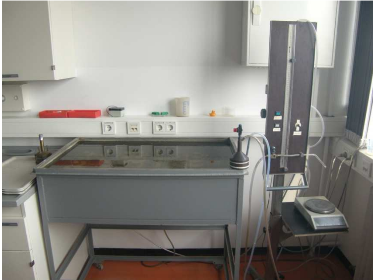
Abbildung 6 Haubenpermeameter zur Bestimmung der gesättigten Wasserleitfähigkeit in Stechzylindern
