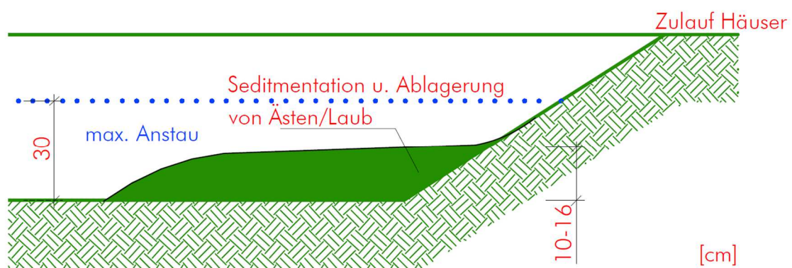
Abbildung 61: Aufhöhung in Folge Ablagerungen im Einlaufbereich Schnittdarstellung Mulden-Rigolen-Element B2 (siehe vorherige Abbildung), Anlage 10
