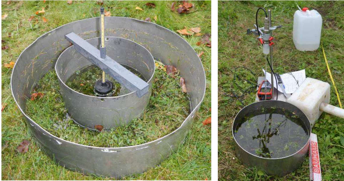
Abbildung 5: Doppelring-Infiltrometer (links) und Einzelring-Infiltrometer (rechts)
