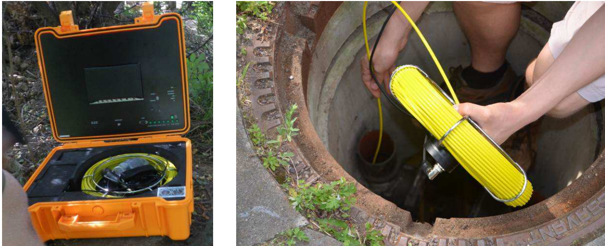
Abbildung 11: Materialien zur Drainrohrinspektion
